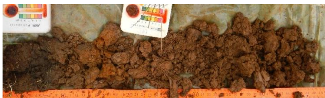
Abb. 64 Bohrung P6 in vernässter Muldenlage mit Verdichtungen 10 - 30cm
