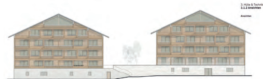
Abb. 6 Ansicht mit durchgehendem Sockel von ca. 65 m Länge
