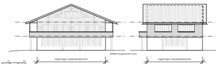
Falls die Fassadenfläche zu mehr als 50 % durch vorspringende Gebäudeteile nach Art. 25 Abs. 1 GBR oder durch offene Gebäudeteile nach Art. 25 Abs. 1ter GBR (Balkon-, Laubenbrüstungen usw.) bedeckt wird ~~oder die Vorbauten aus einer Hängekonstruktion bestehen~~, liegt die Fassadenflucht bei ~~ist der Grenzabstand von~~ der äusseren Brüstung (Vorderkant äusserer Laubenkonstruktion) ~~und der Grenzabstand ist von dort~~ aus zu messen.
